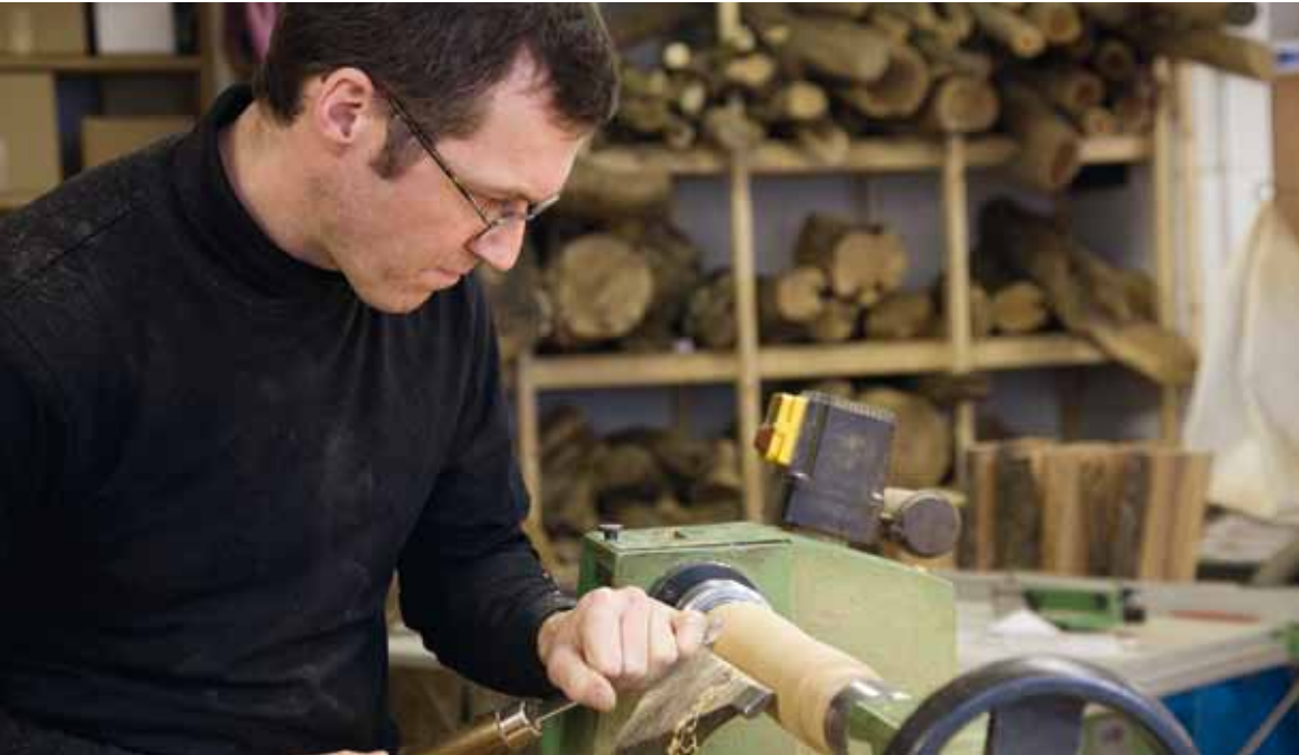
Hergen Böttcher drechselt die Außenkontur der Gewürzmühle. Der Rohling wird tailliert und bekommt Zierrillen.
