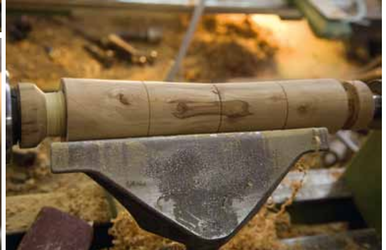
Bild oben: Mühlenkopf mit Zapfen. Er passt in den Mühlenkörper. Bild unten: Die Außenkontur ist fertig. Die Mühle ist links im Bild mit einer gedrehten Aufnahme und rechts mit einem Spannzapfen in der Drechselbank eingespannt.
