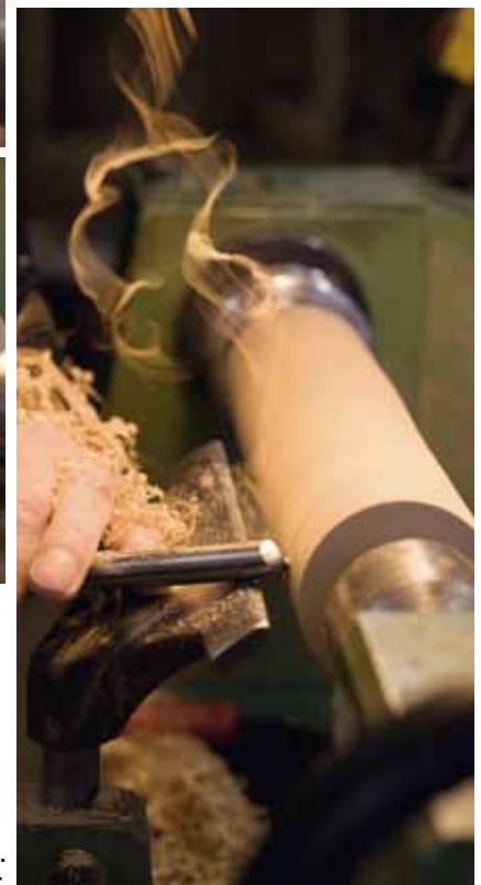
Bild oben: Den Holzstempel spannt der Drechsler in die Drechselbank. Bild unten: Mit der Schrappöhre hat er ihn rund gedreht.
