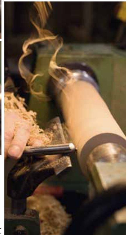
Bild oben: Den Holzstreich spannt der Drechsler in die Drechselbank. Bild unten: Mit der Schrappöhre hat er ihn rund gedreht.
