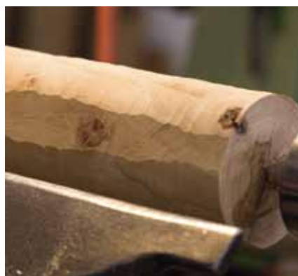
Bild oben: Den Holzstempel spannt der Drechsler in die Drechselbank. Bild unten: Mit der Schrappöhre hat er ihn rund gedreht.
