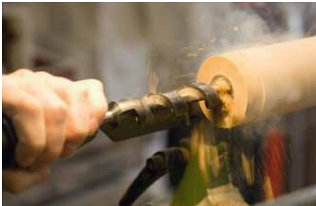
Erst mit dem Forstnerbohrer, dann mit dem Schlangenbohrer. In den Mühlenkörper kommt später das Mahlwerk.
