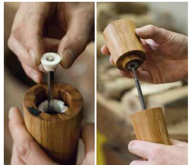
Das Keramikmahlwerk aus Österreich kommt zum Schluss in die nur von außen geölte Mühle.
